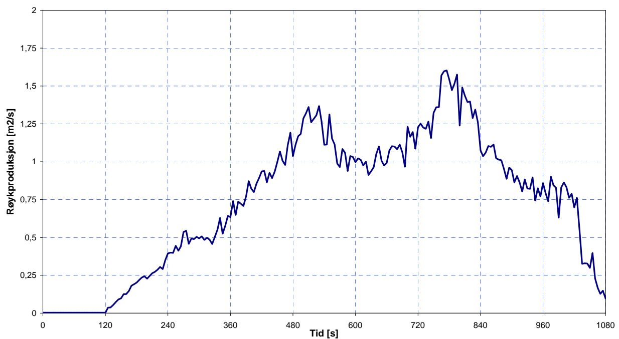
Figur 2 Røykproduksjon som funksjon av tid i løpet av prøving av Astro Safe i henhold til NT FIRE 036.
