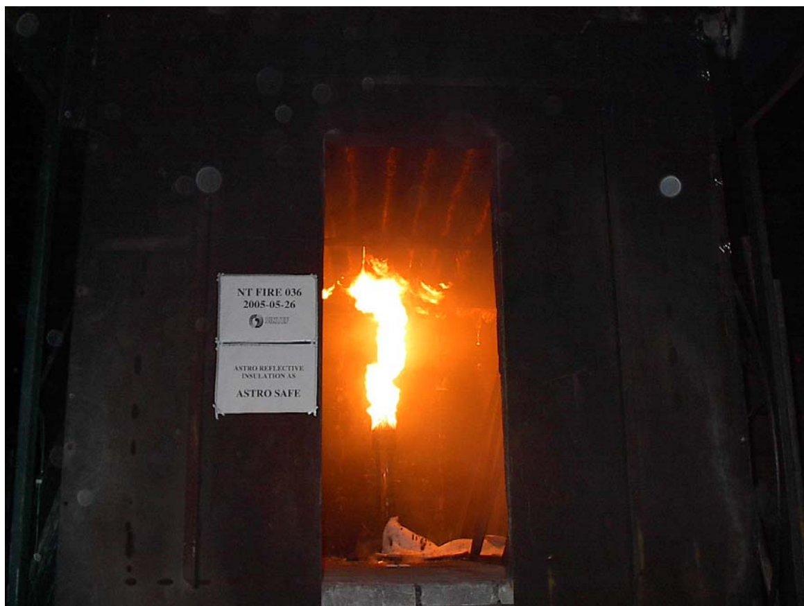
Foto 6 Astro Safe etter 10 minutters prøving.
