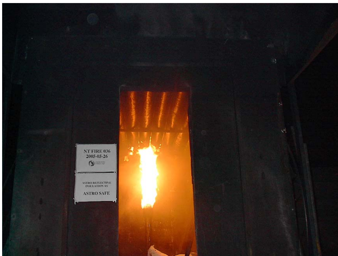
Foto 5 Astro Safe etter 5 minutters prøving.
