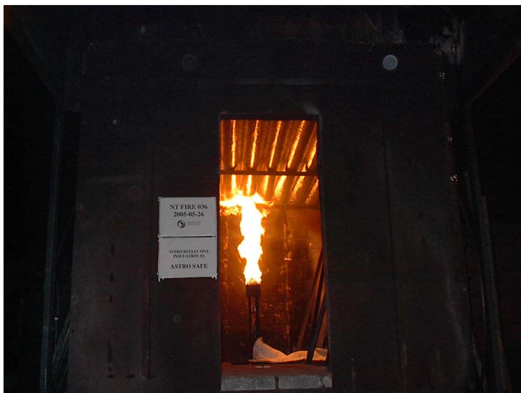
Foto 3 Astro Safe etter 45 sekunders prøvingstid
