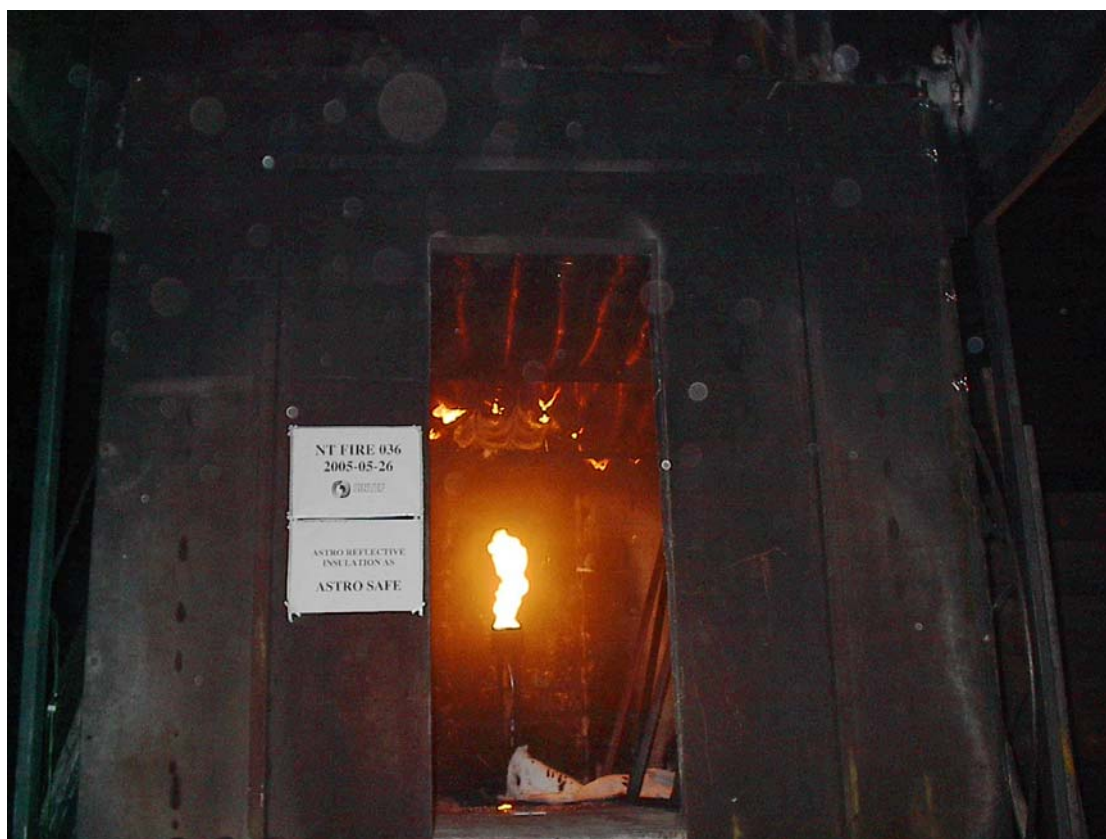
Foto 7 Astro Safe etter 15 minutters prøving – akkurat idet brenneren blir stengt av.
