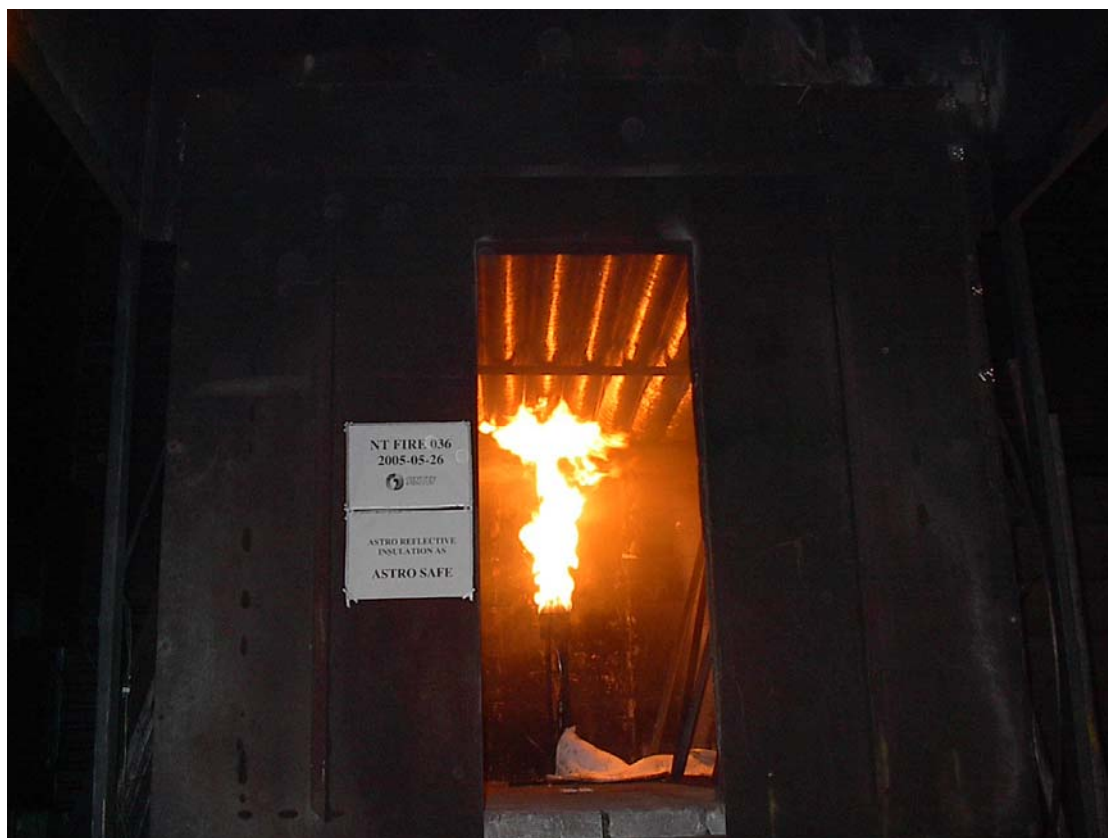
Foto 4 Astro Safe etter 1 minutt 30 sekunders prøving.
